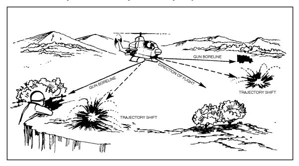
Figure 4-3. Trajectory shift
